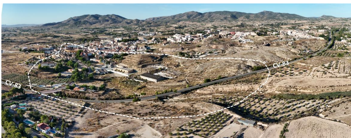
Figura 17. Panorámica de la zona principal del núcleo urbano afectada por las deformaciones. La delineación del límite de la zona afectada por subsidencia es aproximada.
