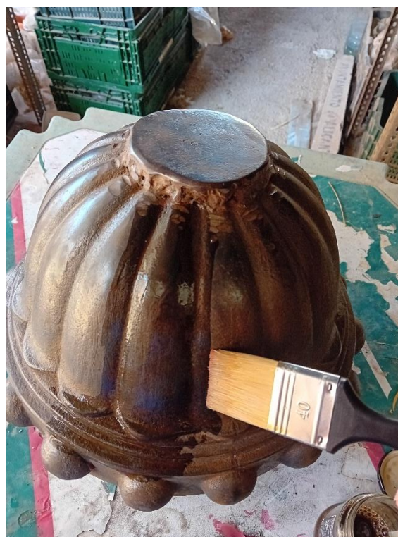
Fig. 19; Consolidación del metal.
